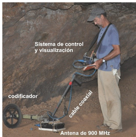
Figura 3.5: Las antenas se pueden conectar a la rueda del codificador, que se pueden configurar para recopilar un número determinado de trazos de reflexión a cada distancia programada a lo largo del suelo.
