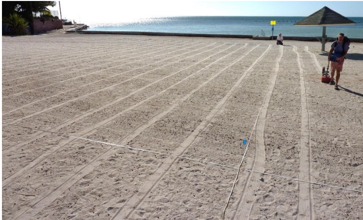
Figura 3.4: Los perfiles de reflexión se recogen mediante antenas en movimiento, aquí antenas de frecuencia central de 400 MHz, a lo largo del suelo en transectos separados por 1 metro. Cada perfil consta de muchos cientos o miles de trazas de reflexión individuales a lo largo de cada línea de levantamiento.
