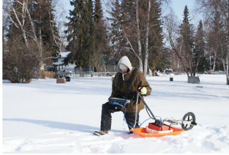
Figura 3.25: Recopilación de datos GPR en nevadas intensas. La nieve permite un buen acoplamiento de energía con el suelo subyacente, pero la energía se esparcirá en la capa de nieve y producirá reflejos menos distintos desde el punto de vista aéreo en el suelo.
