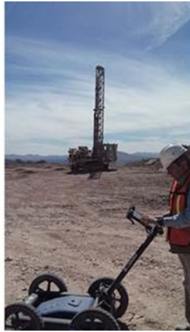
Figura 2.5: Localizando túneles y pozos en una mina a cielo abierto que antiguamente era subterránea y data del siglo XIX
