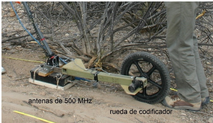
Figura 3.12: Las antenas de frecuencia más alta (aquí una frecuencia central de 900 MHz unida a una rueda de medición) son muy pequeñas y se pueden maniobrar fácilmente por el suelo.
