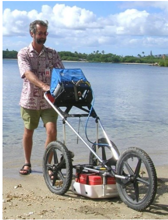
Figura 3.7: Algunos sistemas GPR se pueden montar en un carro para que los opere una persona con el codificador que mide la distancia y coloca trazas en el espacio operado por la rueda del carro.
