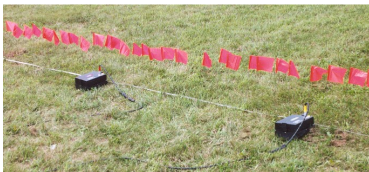
Figura 5.3: En las pruebas CMP, el envío y la recepción separados se mueven en pasos (en esta prueba indicados por banderillas a distancias medidas, con trazas de reflexión individuales se registran en cada ubicación).
